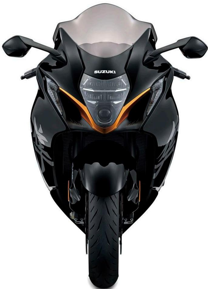
O SDMS-a – Suzuki Drive Mode Selector Alpha permite selecionar um de três modos de condução pré-definidos. Modo A (Active), modo B (Basic) e modo C (Comfort). Cada um destes modos ajusta automaticamente os parâmetros de potência do motor, controlo de tração, controlo “anti wheelie”, controlo do efeito travão motor, e ainda a sensibilidade do quickshift bidirecional.
