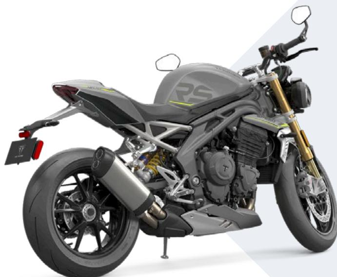
complementado na traseira por um subquadro, também em alumínio. Conforme referimos, a Speed Triple 1200 RS pesa 198 kg a cheio. E em grande parte este valor é conseguido graças ao novo quadro 17% mais leve do que a anterior geração, e que pela sua geometria coloca mais peso na roda dianteira.
