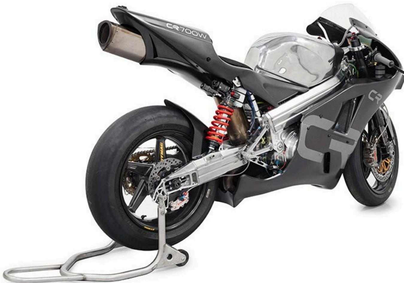
Com uma potência máxima de 220cv, debitada às 10.500 rpm, e um binário de 142 Nm às 9.500 rpm, este pequeno motor, com apenas três partes móveis, mede uns escassos 34 cm de comprimento e 24 cm de diâmetro e pesa uns singelos 24 kg, que sobem para 43 kg quando a transmissão dedicada de seis velocidades lhe é acoplada.
