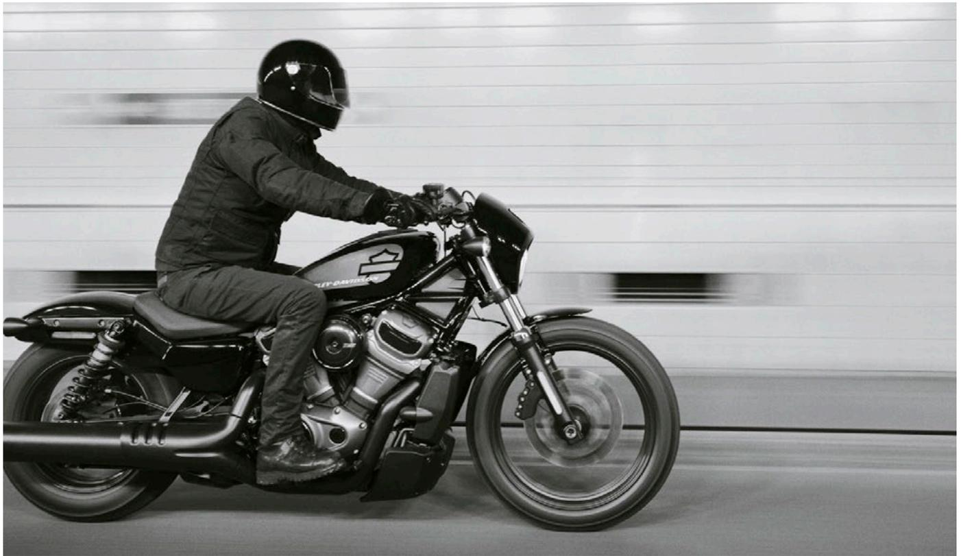
Traction Control System (TCS) Concebido para evitar que a roda traseira patine excessivamente durante a aceleração. O TCS pode melhorar a confiança do condutor quando a tração disponível é comprometida por piso molhado, uma mudança inesperada na superfície ou ao conduzir numa estrada não pavimentada. O motociclista pode desativar o TCS em qualquer Modo de Condução quando a moto estiver parada e o motor a trabalhar.
