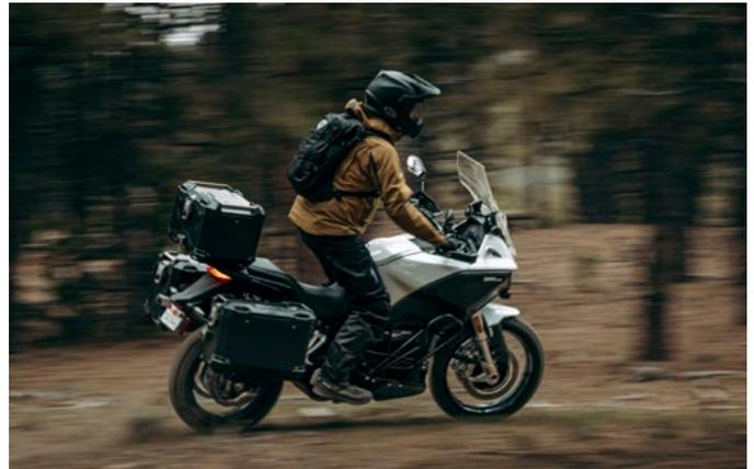
166 Nm de torque, potência de 74 cv e pode alcançar 167 km/h, com baterias de 14,4+ kWh e tempo de carregamento de 4-5 horas com o carregador de série de 3 kW. A SR está disponível na cor Thermal Black.
