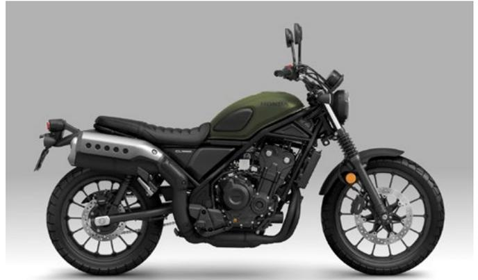
treliça, tipo diamante, que garante uma ciclística de fácil manabilidade. Para garantir conforto e segurança, a suspensão frontal é constituída por uma forquilha telescópica de 41 mm de diâmetro e 150 mm de curso. A suspensão traseira é formada por um braço oscilante fabricado em tubo e dois amortecedores com curso de 145 mm que proporcionam 5 níveis de afinação da pré-carga da mola.
