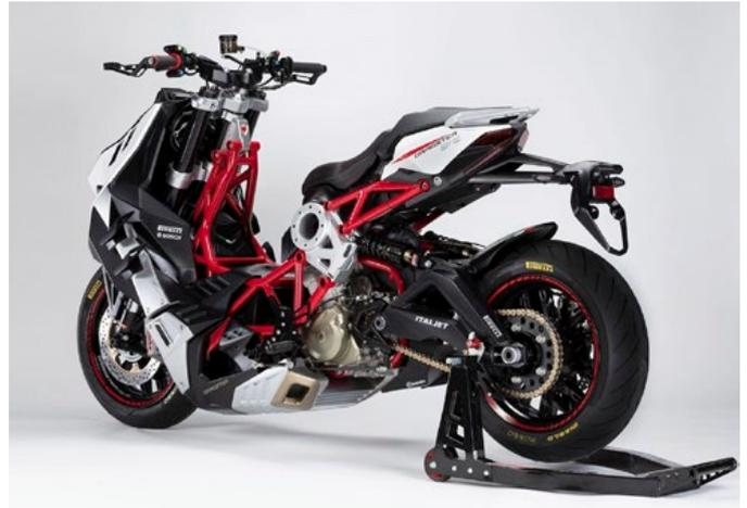
oscilante que é em fundição de alumínio. Ambas as suspensões da Dragster 500GP são completamente ajustáveis.
