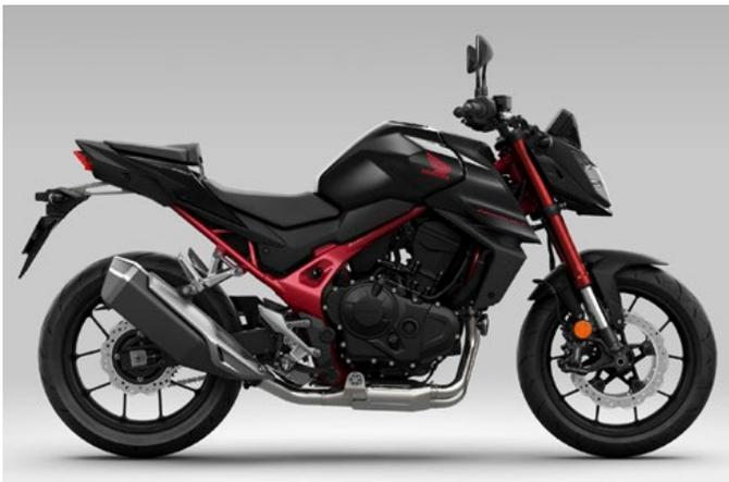
qualidade da condução, a Hornet tem jantes leves, com raios em forma de Y, com jante de 3,5 polegadas e pneu 120/70-ZR17 na frente e de 4,5 polegadas e pneu 160/60-ZR17 na traseira.
