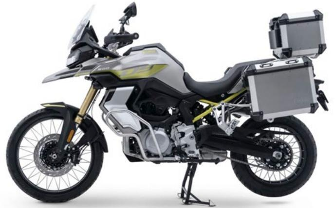
para as motos da marca bávara. Neste caso, falamos do bicilíndrico paralelo de 895 cc com arrefecimento por líquido, de onde são retirados uns esplêndidos 97.8 cv e 86.7 Nm.
