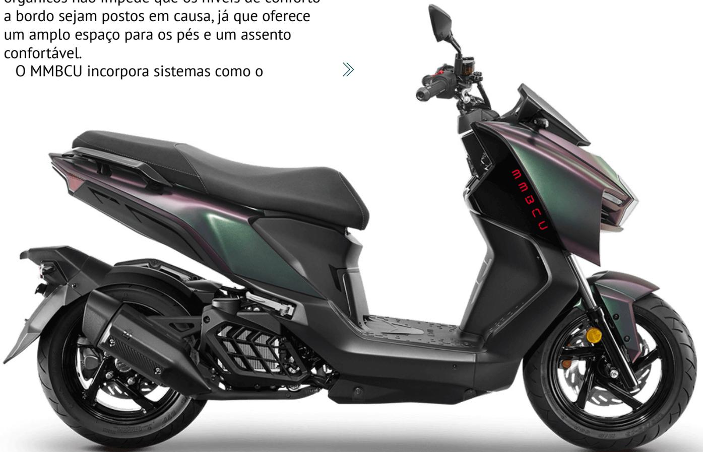
alternador acoplado diretamente na cambota, que proporciona um arranque mais suave e silencioso, além de uma maior eficácia energética. Controlo de tração, iluminação integral em LED, ABS de dois canais, painel de instrumentos em LCD de elevado contraste, são outros argumentos a destacar. O motor a quatro tempos tem refrigeração por líquido.
