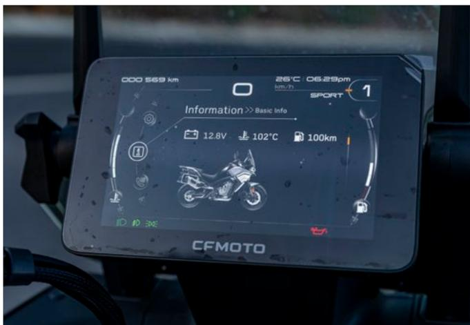
composto por um ecrã TFT a cores de 7 polegadas que é facilmente navegável através dos comandos no punho esquerdo. Os modos de condução (Sport e Rain) não são personalizáveis nem podemos desligar o ABS, mas podemos ver a temperatura exterior e a do motor, as horas, a velocidade, o regime do motor, a mudança engrenada, autonomia e a quantidade de combustível disponível. Além de podermos seguir as indicações do GPS e fazer ou receber chamadas telefónicas.
