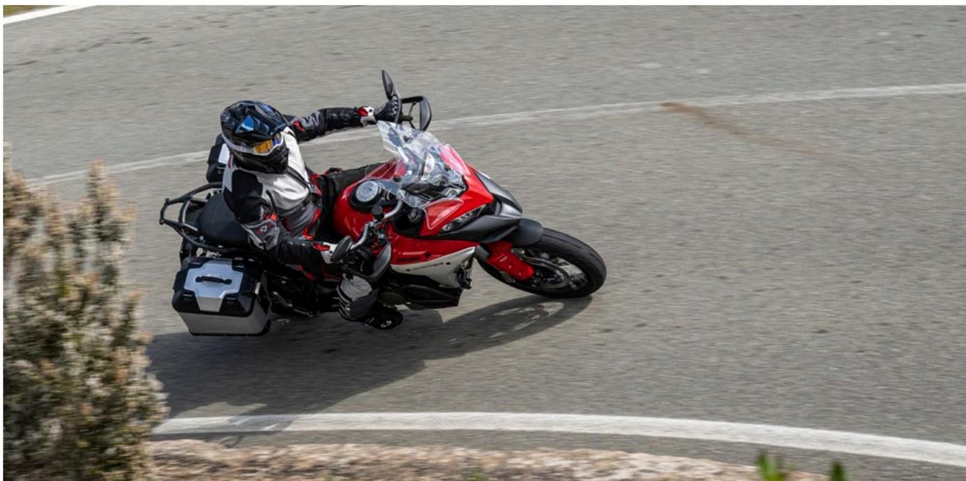
*"O CORNERING ABS RECEBE OS DADOS DE INCLINAÇÃO DA MOTO EM TEMPO REAL DESDE A IMU DE SEIS EIXOS.."*
