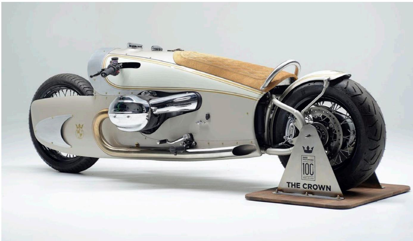
fabricados em aço inoxidável. Também o assento foi construído em chapa de alumínio, e forrado a pele verdadeira.
