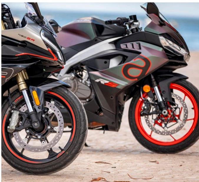
quadros rígidos. A CFMOTO 450SR parece ter sido desenhada com isso em mente, apresentando uma forquilha invertida e um monoamortecedor traseiro montado numa estrutura multi-link. A sensação de confiança em curvas rápidas é notável e os travões Brembo garantem uma travagem eficaz de fácil dosagem, mesmo nas situações mais exigentes.
