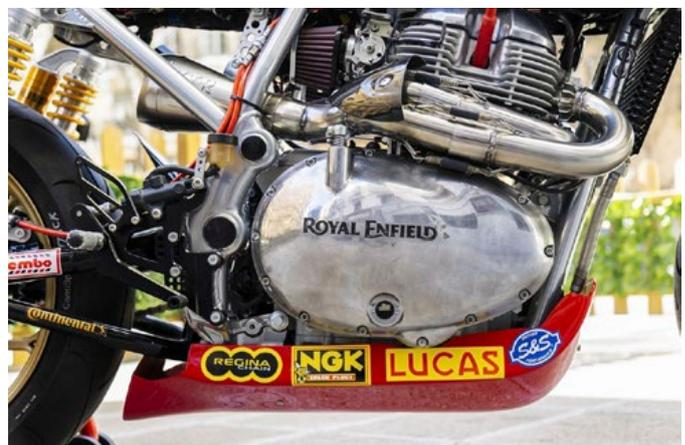
suportes de alumínio. O motor também foi alvo de melhorias, recebendo cames da S&S, pistões de alta compressão e um módulo de mapeamento de combustível Power Commander da Dynojet. Filtros de ar DNA e um escape curto e personalizado foram adicionados para melhorar o fluxo de ar.
