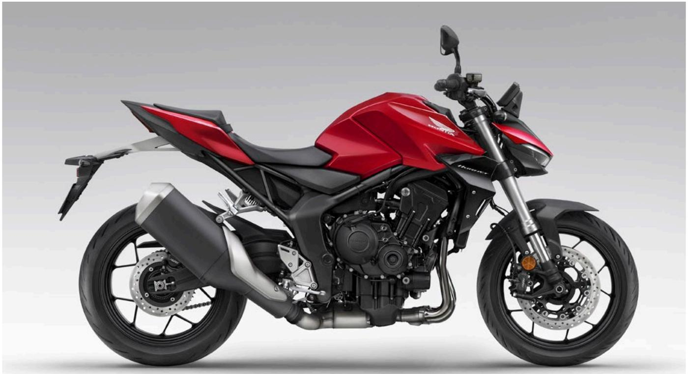
**N**a versão standard, a CB1000 Hornet está equipada com um motor tetracilíndrico de 1000cc, capaz de debitar 150cv (112 kW) às 11.000 rpm e 104 Nm de binário às 9.000 rpm. O novo quadro de dupla trave em aço oferece 70% mais rigidez à torção em comparação com a versão anterior, o que melhora significativamente a maneabilidade da moto.
