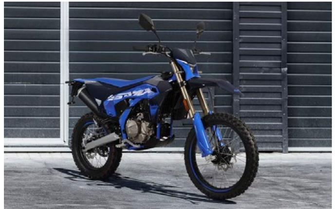
e uma distância ao solo de 304 mm. A distância entre eixos é de 1.445 mm, contribuindo para uma maior estabilidade e manobrabilidade em terrenos desafiantes. Os pneus 90/90-21 na frente e 140/80-18 atrás são aptos para diferentes superfícies.
