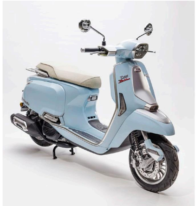
distintivas da marca, a começar pela suspensão dianteira com duplo amortecedor hidráulico e monoamortecedor hidráulico com pré-carga ajustável em 5 posições na suspensão traseira.
