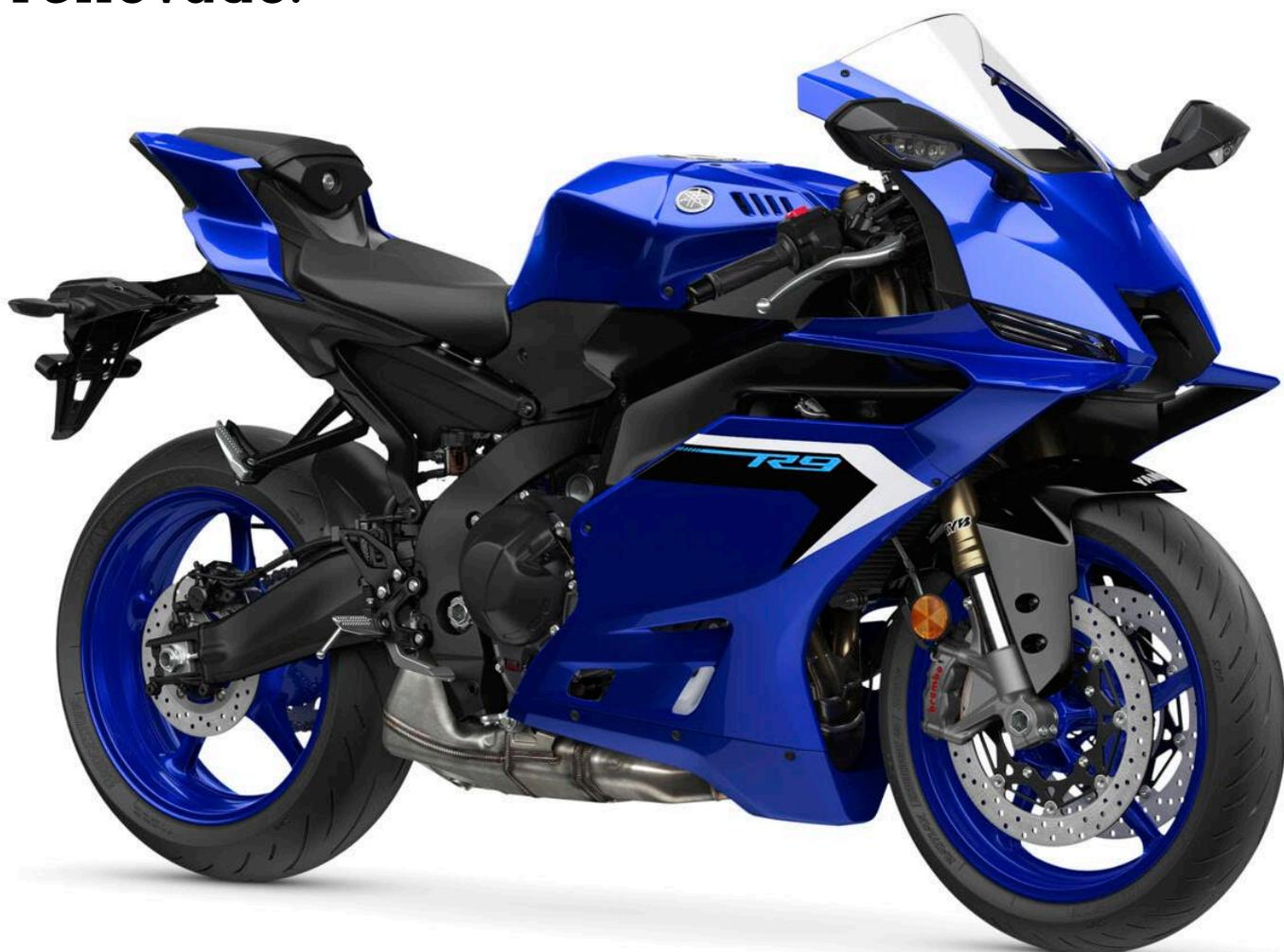
**D**esde a sua fundação, em 1955, a Yamaha tem-se destacado nas competições de motociclismo, pelo que esta nova R9 não é exceção. Equipada com um motor CP3 de 890 cc, refrigerado a líquido e com 3 cilindros em linha, este motor a 4 tempos oferece uma potência máxima de 87,5 kW (117 cv) às 10.000 rpm e um binário de 93,0 Nm às 7.000 rpm.
