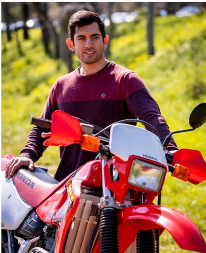
e as suspensões absorvem praticamente tudo o que possam imaginar, mesmo sendo a Kayaba dianteira de 46 mm do tipo convencional. O próprio quadro de alumínio tem uma rigidez impressionante e melhora as sensações na condução.
