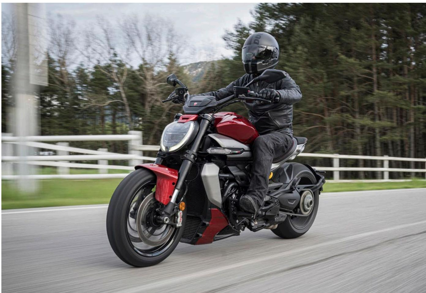
Naturalmente que o escape, com as suas quatro ponteiras negras, do lado esquerdo, é outro elemento de destaque, tal como o monobraço traseiro e a vistosa jante de cinco braços, equipada com um largo pneu de 240/45-17.
