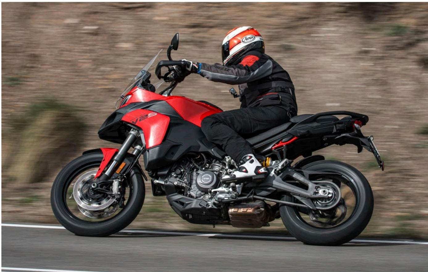
"A DUCATI PARAMETRIZOU A **POTÊNCIA** GERADA PELO MOTOR V2 PARA UM MÁXIMO DE 115 CV REGISTRADOS ÀS 10.750 RPM"
